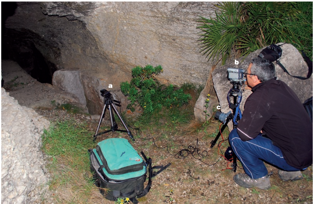
Figura 14. Montaje del material utilizado en el seguimiento de poblaciones amenazadas de quirópteros: (a) detector de ultrasonidos, (b) cámara sensible a la luz infrarroja, (c) foco de luz infrarroja. Cova del Sardiner (Sagunto). Imagen: M. A. Monsalve.
